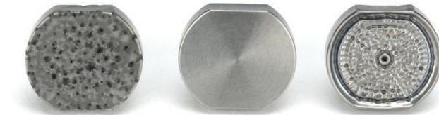
液体中的空化程度在很大程度上取决于该液体的表面张力，并且表面张力越高，空化越剧烈。尽管通常选择水作为选择液体，因为它是声波扩散的良好介质，但应考虑这样一个事实，超声波探头在水中的腐蚀速度通常比在有机溶剂中快5倍。
